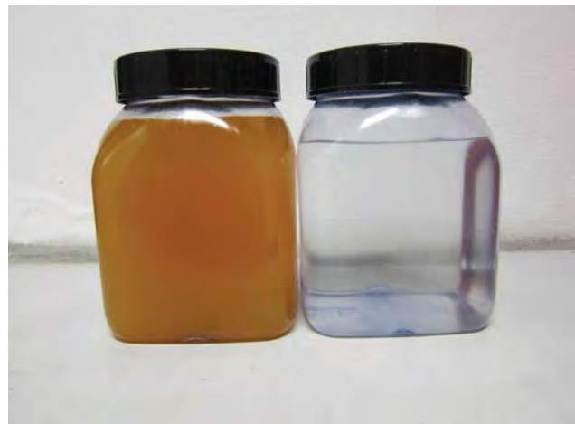
Wasserqualitäten im K40- System vor und nach Einbau der EnwaMatic®
