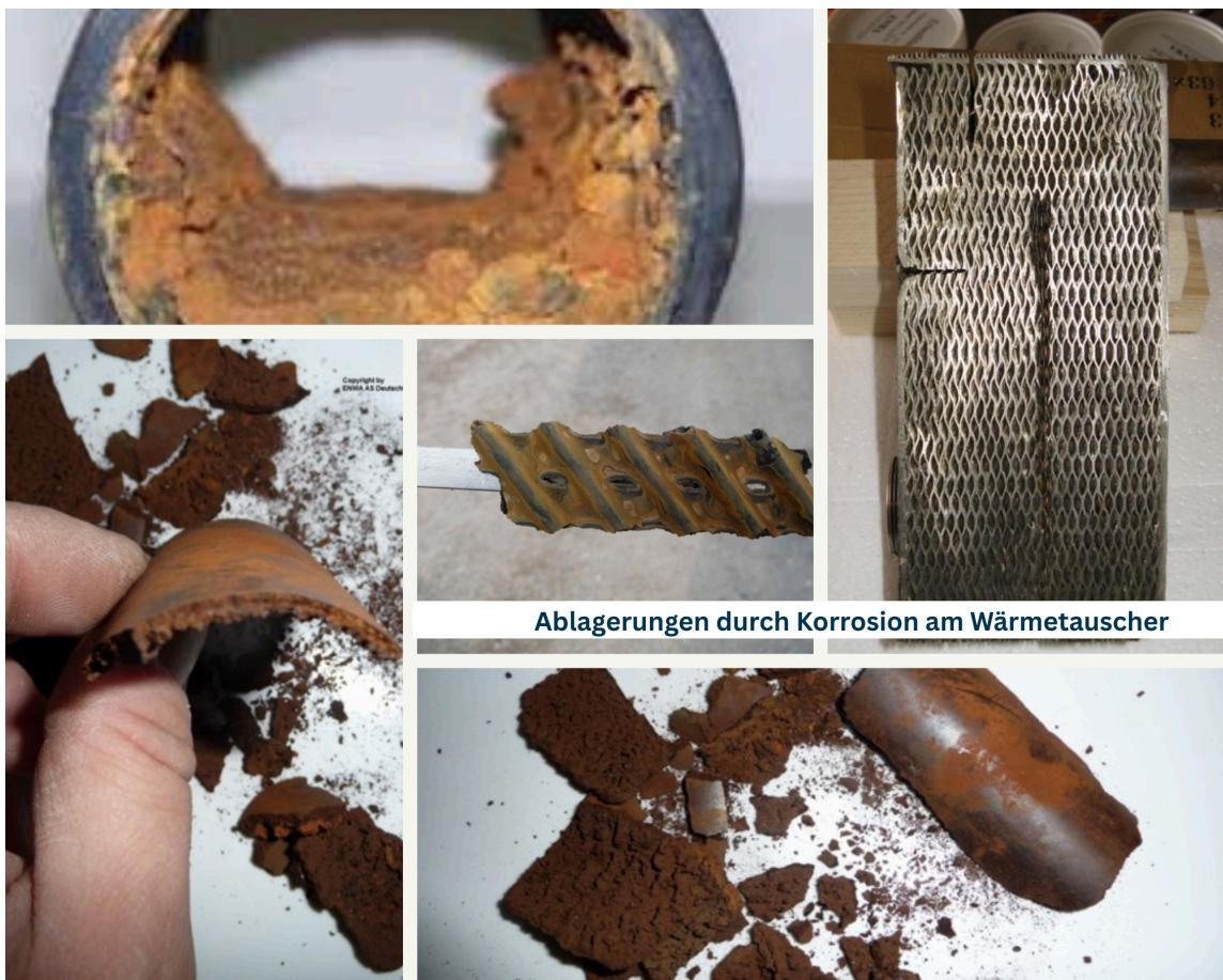
**Ablagerungen durch Korrosion am Wärmetauscher**
