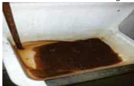
Partikel, die bei der automatischen Rückspülung aus dem Heizsystem entfernt werden - Dank der Effizienz des 5µm Feinfilters der EnwaMatic
