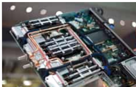
Wasserkühlung der IBM Servereinheiten Quelle: IBM Research
